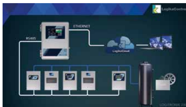
Sala compressori gestita da LogiTronik 200 + LogikaCloud.
