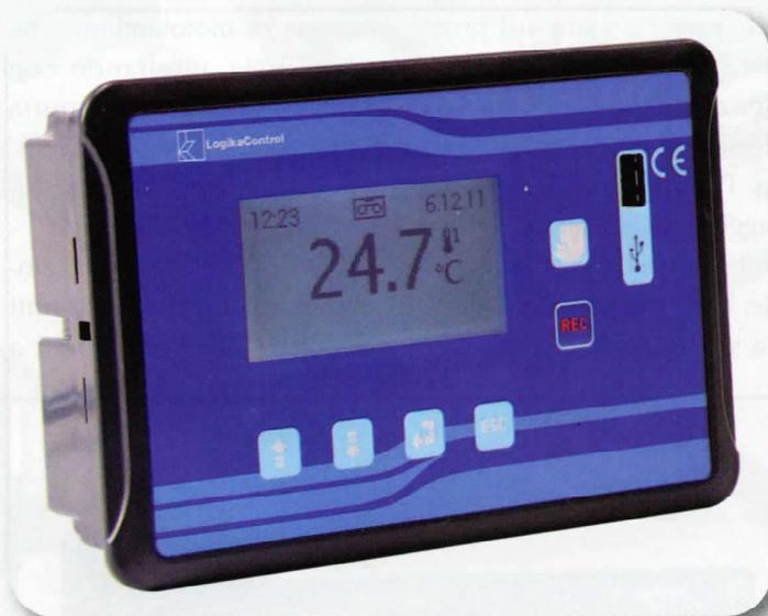
allarmi. Attraverso la porta USB, i dati registrati possono essere scaricati su una comune flash drive per poi essere trasferiti a loro volta a PC dove, grazie al software applicativo WinRecorderStore in dotazione, saranno elaborati e stampati tramite grafici e/o statistiche.
